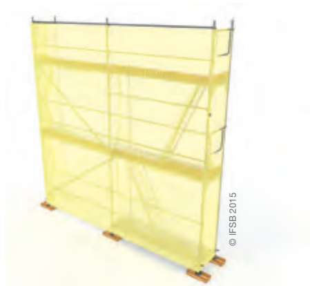
Échafaudage avec filet
