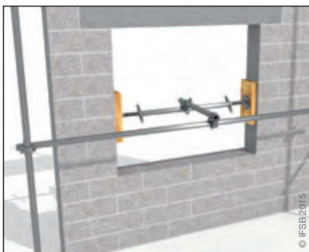
Ancrage par étrésillons (vérins)
